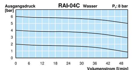
\*1 bei 8 bar Eingangsdruck, 6 bar Ausgangsdruck und 1 bar Druckabfall
