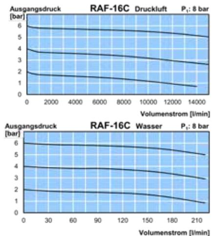
\*1 Bei Wasser-Strömungsgeschwindigkeit von 2 m/s. \*2 Bei Druckluft ist der Volumenstrom um den Faktor 70 größer.
