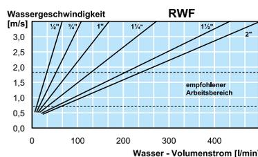
\*1 bei Wasser-Strömungsgeschwindigkeit von 2 m/s. \*2 bei Druckluft ist der Volumenstrom um den Faktor 70 größer.
