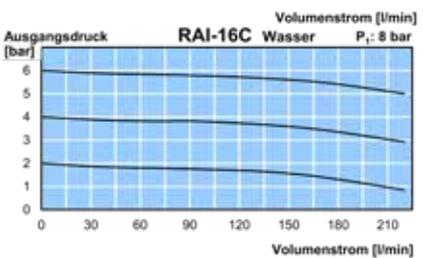
\*1 bei 8 bar Eingangsdruck, 6 bar Ausgangsdruck und 1 bar Druckabfall
