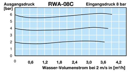
\*1 bei Wasser-Strömungsgeschwindigkeit von 2 m/s. \*2 bei Druckluft ist der Volumenstrom um den Faktor 70 größer.
